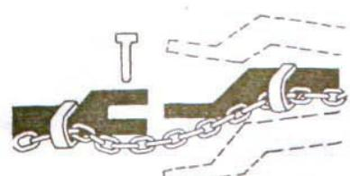
Используя соответствующий тип держателя, зафиксируйте один край цепи к опоре сцепного устройства, а другой край – к опоре анкера. Необходимо, чтобы цепь слегка провисала для осуществления поворотов. Обратитесь к дилеру за помощью в выборе соответствующего типа цепи, чтобы она смогла выдержать полную массу буксируемого оборудования или транспортного средства. Не используйте предохранительную цепь в целях буксировки.
