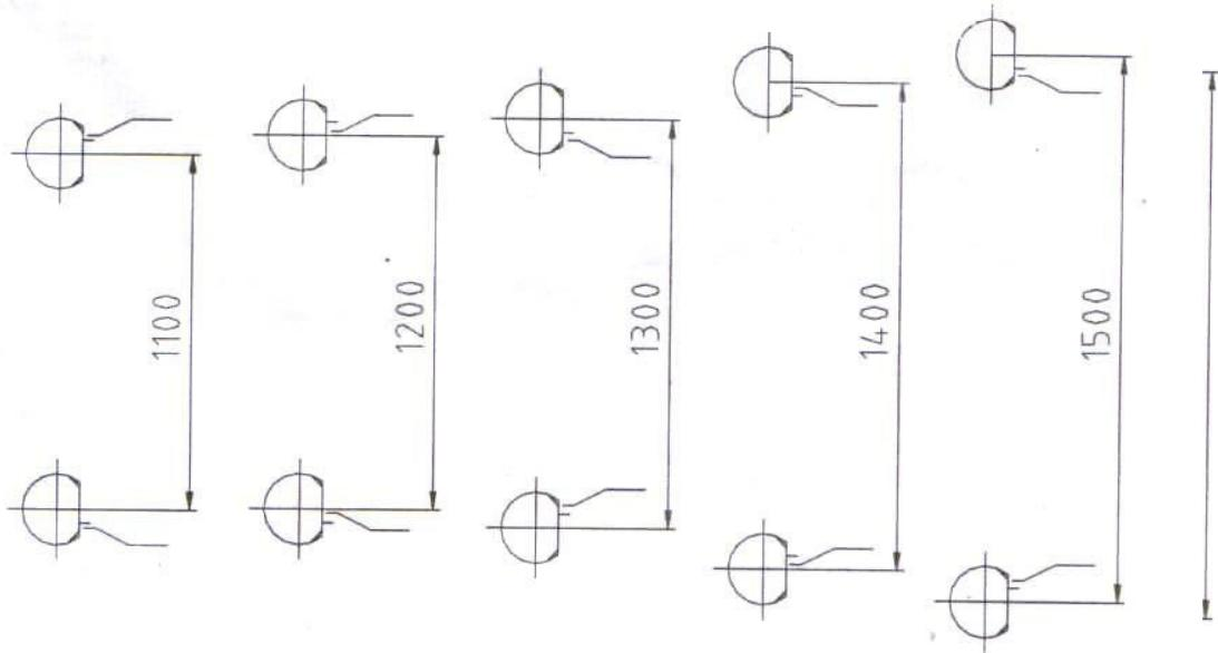
Рис. 7. Регулировка расстояния между серединами колес задней оси.
