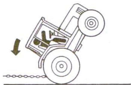
При необходимости буксирования другого транспортного средства или оборудования, используйте сцепное устройство или длинную цепь (кабель не рекомендуется).
