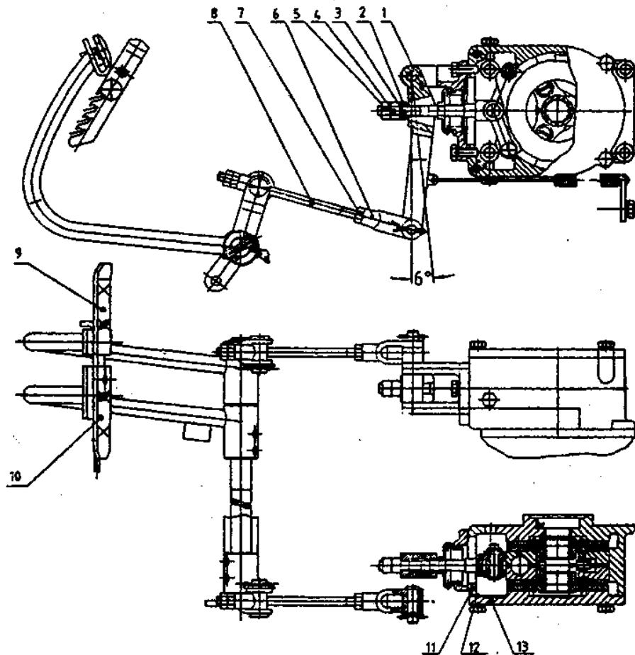
Рис. 13. Регулировка дискового торможения.
