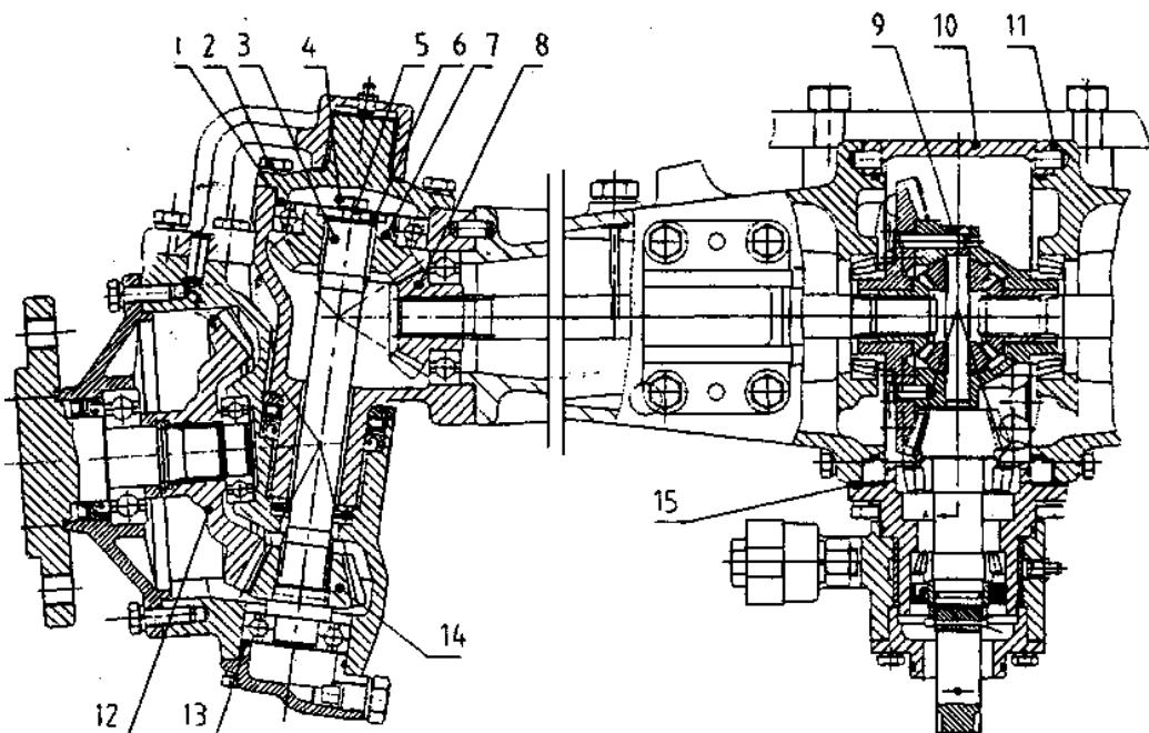
Рис. 9. Схема передней ведущей оси.
